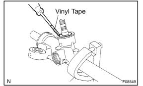
5. REMOVE RACK GUIDE SPRING CAP LOCK NUT
