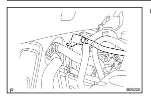
(d) Remove the fuel pipe clamp.
