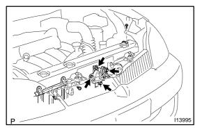
1. DISCHARGE REFRIGERANT FROM REFRIGERATION SYSTEM
