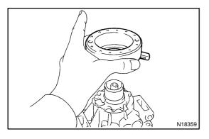
(d) Remove the stator.
